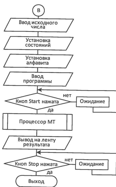
Рис. 7. Укрупненная схема алгоритма блока решения оригинальных задач
