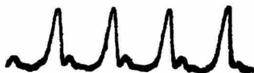
**Рис. 7.** Осциллограмма излучения гелий-неонового лазера ЛГ-79.
