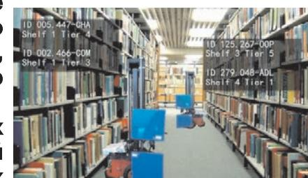
Кроме того, рука робота может регулировать положение антенны RFID в целях сохранения оптимальной дистанции сканирования тегов (при слишком большой дистанции пропадает сигнал, а при очень короткой антenna может повредить полку).
